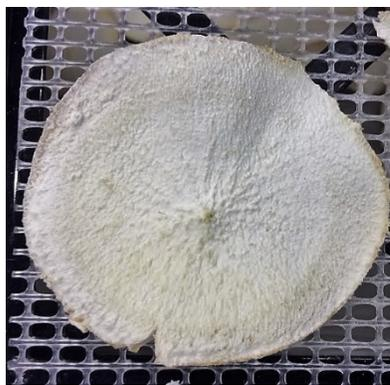
**Figura 5.** Lascas de yuca luego de un periodo de secado de 4.5 horas a 71°C.
