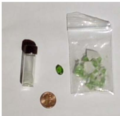
**Figura 4.7** Muestra de vidrio  $\text{SiO}_2$ :  $\text{Al}_2\text{O}_3$ :  $\text{Sb}_2\text{O}_3$ :  $\text{CaO}$ :  $\text{Na}_2\text{O}$ :  $\text{Cr}_2\text{O}_3$
