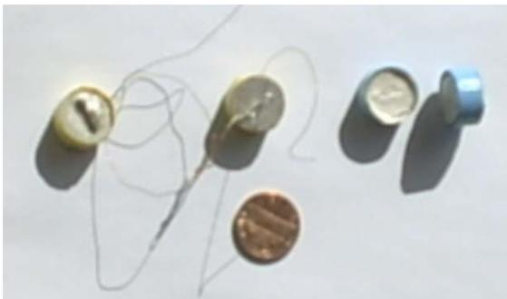
**Figura 4.9** Capacitores a base de policristales
