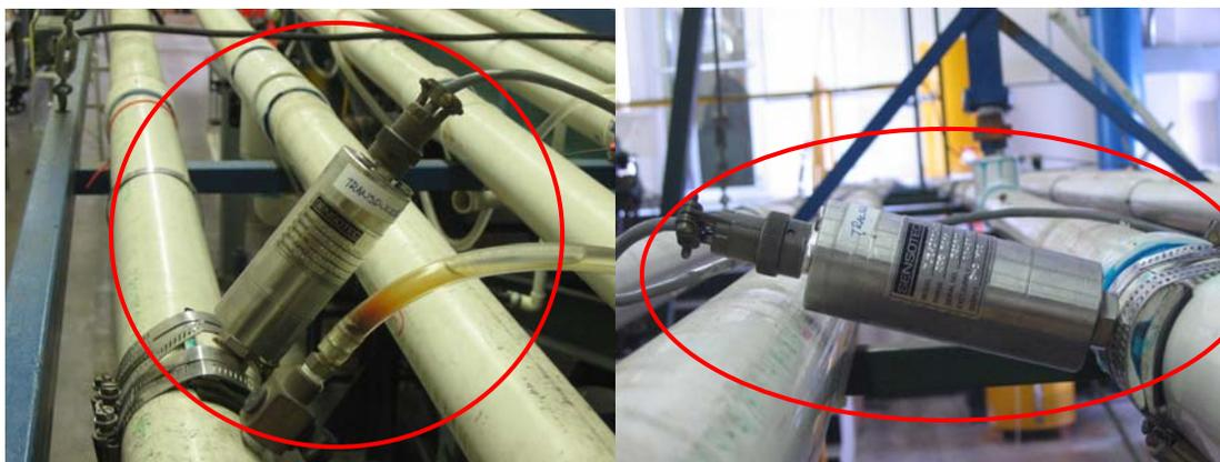
**Figura 37. Transductores de presión.**
