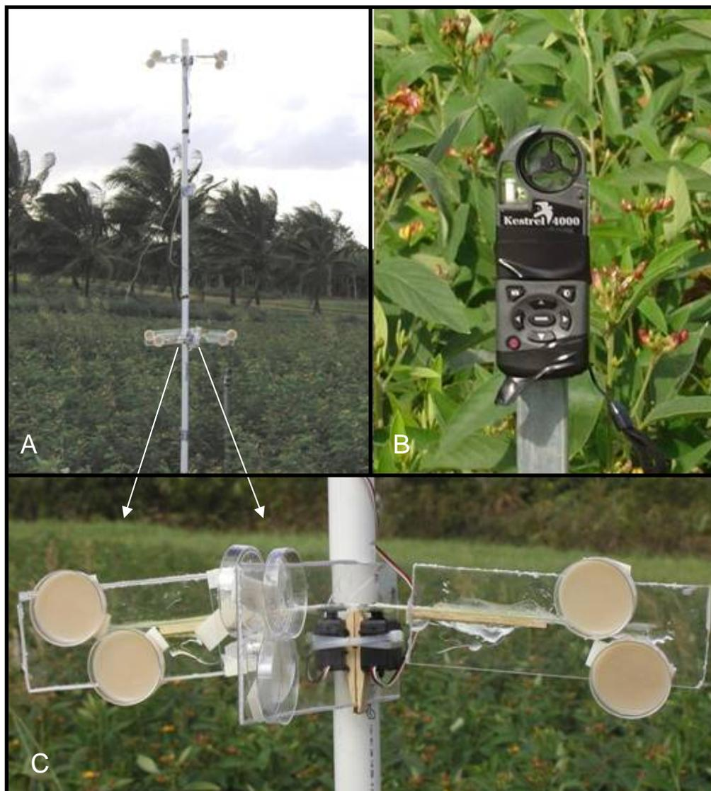
**Figura 2.** (A) Atrapador de esporas conteniendo los platos Petri, localizado en medio de la siembra de gandul comercial, (B) Monitor Kestrel 4000 para medir las condiciones ambientales al momento del muestreo, (C) acercamiento del muestreador conteniendo los platos Petri.
