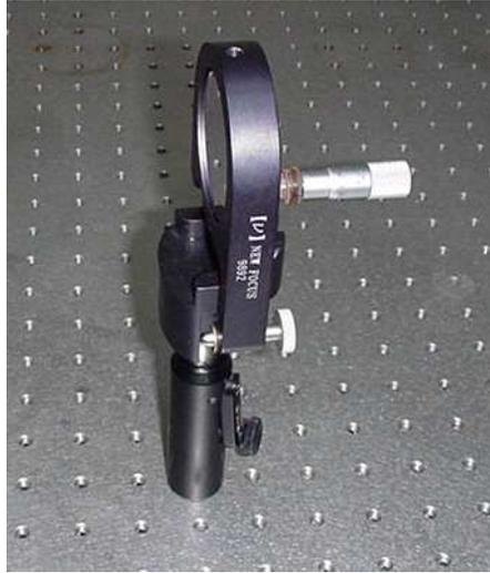
Figura 3.3: Espejo  $M_1$ , al cual se acopló un micrómetro para cuantificar sus inclinaciones.
