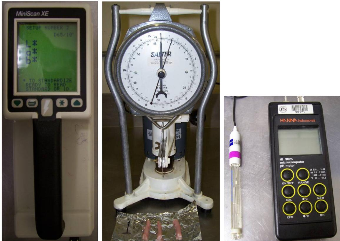
Figura 8. Instrumentos utilizados para evaluar calidad de carne: Colorímetro, Warner Bratzler y Metro de pH.
