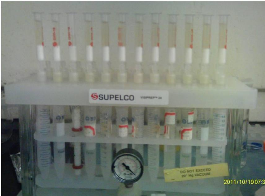
**Ilustración 13: Proceso de Extracción en Fase Sólida**
