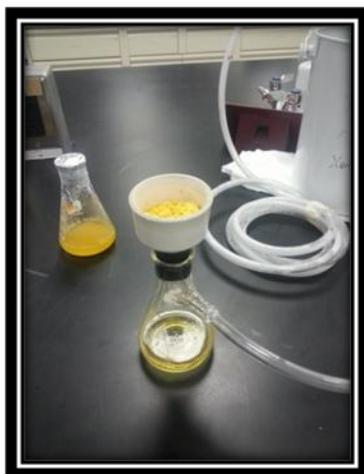
**Figura 3.3** Montaje de Filtración al Vacío
