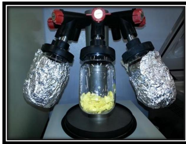
**Figura 3.1** Liofilización de pulpa de mango.
