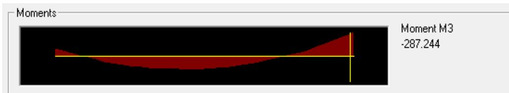
**Figura 13: Diagrama de momento para la viga crítica de la estructura típica no. 1 de acuerdo al Reglamento de Planificación No. 7 (1968)**
