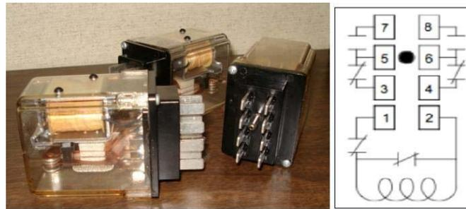
Figura 5.37: Relé de transferencia de encendido.
