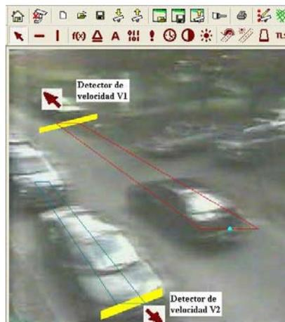
Figura 5.26: Configuración de detectores de velocidad en la imagen de estudio
