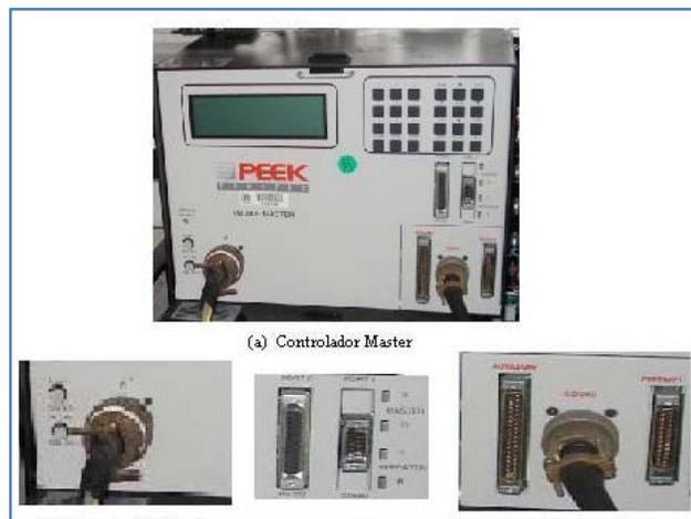
Figura 4.20: Controlador Maestro y conectores
