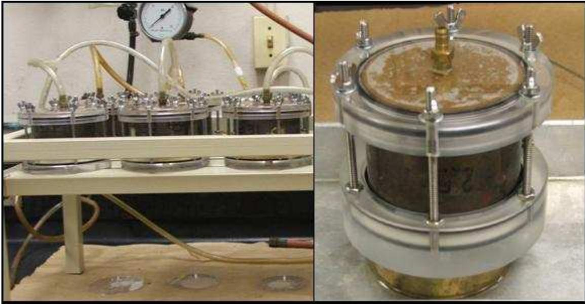
**Figura 8. Sistema de celdas de presión Tempe, para realizar curvas de retención de humedad del suelo.**
