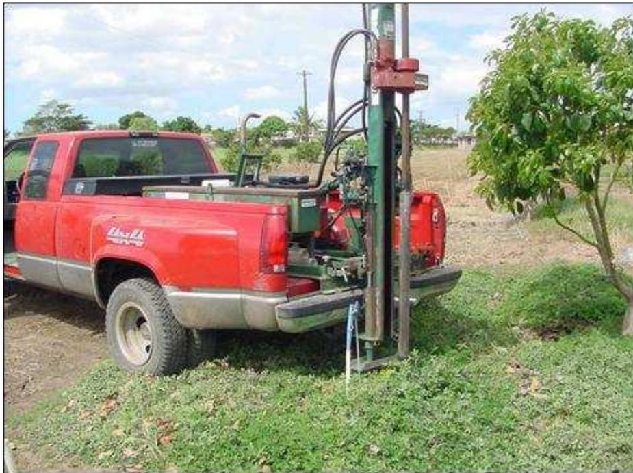
**Figura 5. Muestreo de suelo con barrena hidráulica Giddings.**
