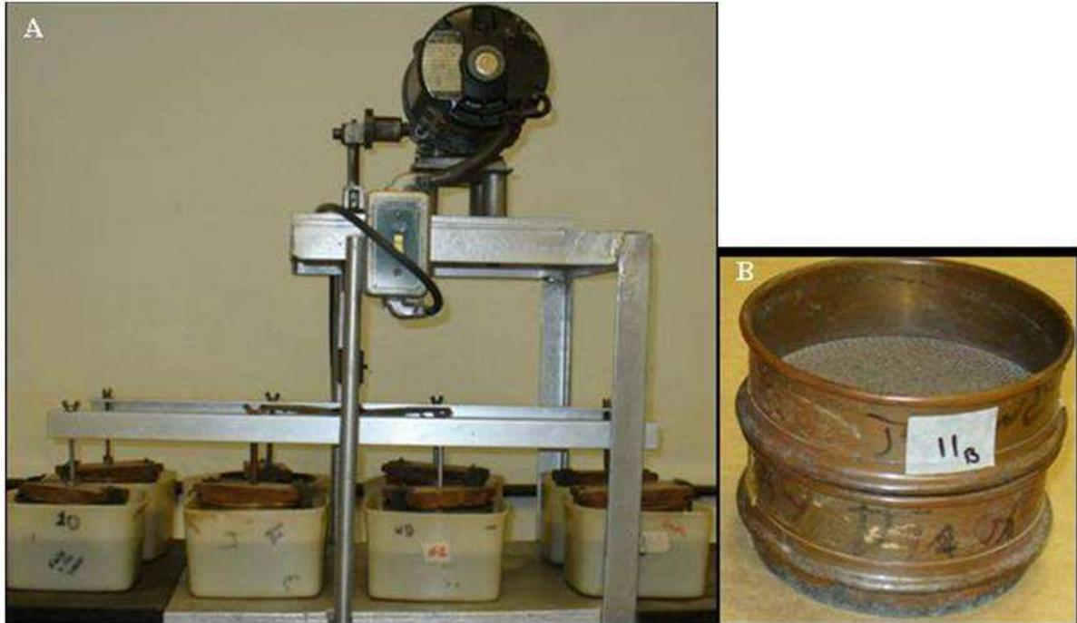
**Figura 7. A) Máquina agitadora para estabilidad de agregados. B) Agregados en tamiz No. 10 sobre el 20.**
