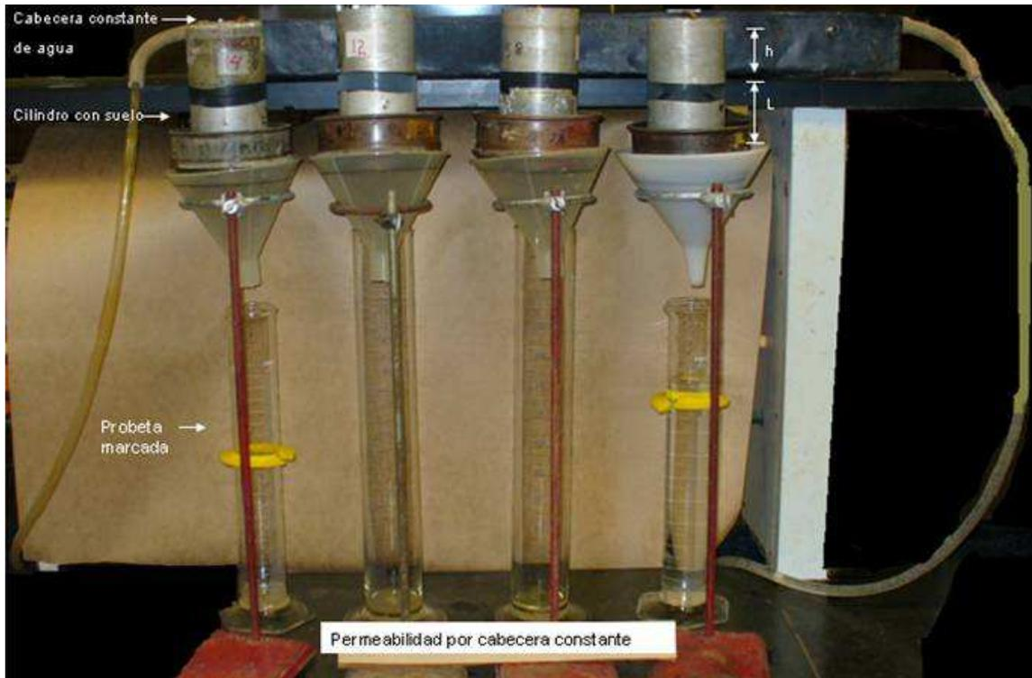
**Figura 10. Sistema de permeabilidad por cabecera constante en laboratorio.**
