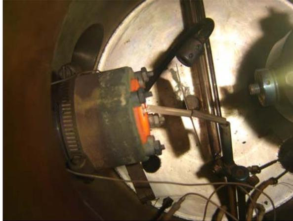
**Figura 4.1** Medida de la temperatura sobre el sustrato ( $T_s$ ) en presencia de oxígeno con una termocupla
