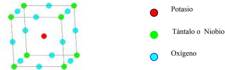
**Figura 1.** Estructura de perovskita del KTN
