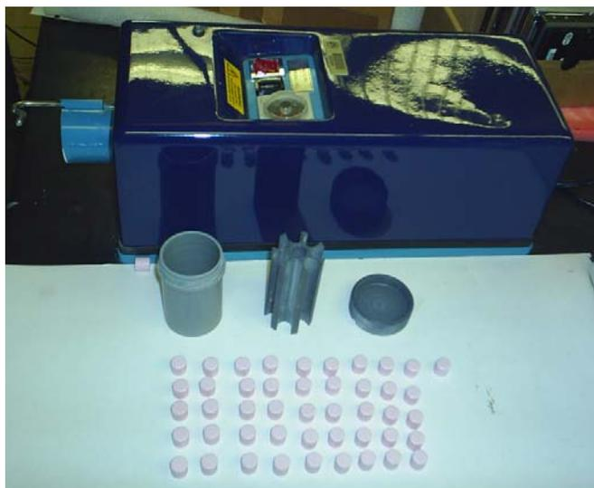
**Figura 3.6** Molino pulverizador de la empresa McCRONE
