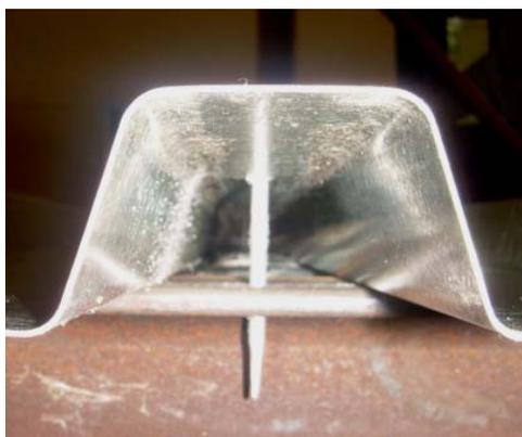
**Figura 5-4 Especimen de prueba con conexiones en las crestas de la lámina**
