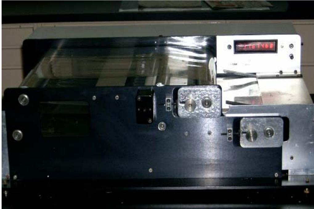
**Figura 4.2. Instrumento utilizado para medir área foliar (Li 3100).**
