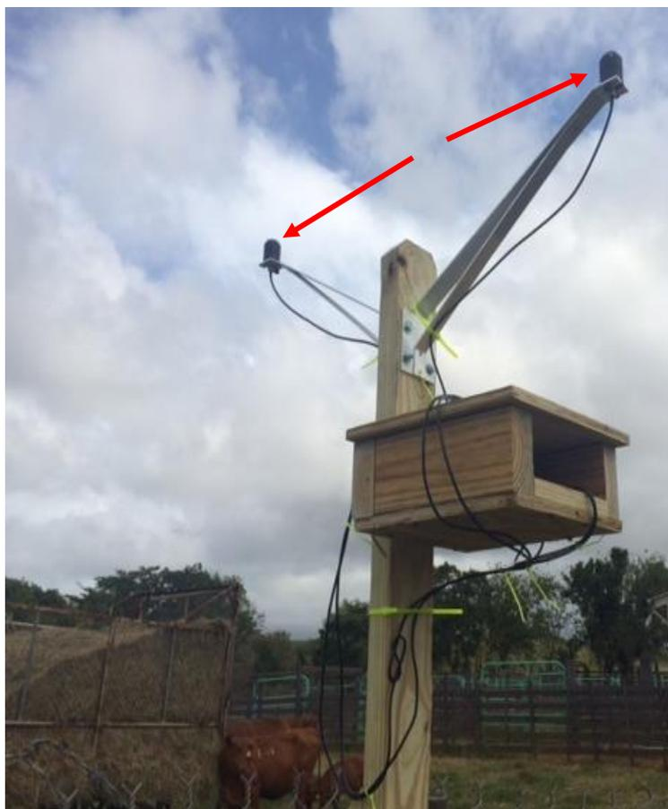
**Figura 1. Piranómetros (n=2) utilizados en la presente investigación (Silicon Pyranometer Smart Sensor S-LIB-M003, Onset Computer Corporation; Bourne, MA, Estados Unidos).**
