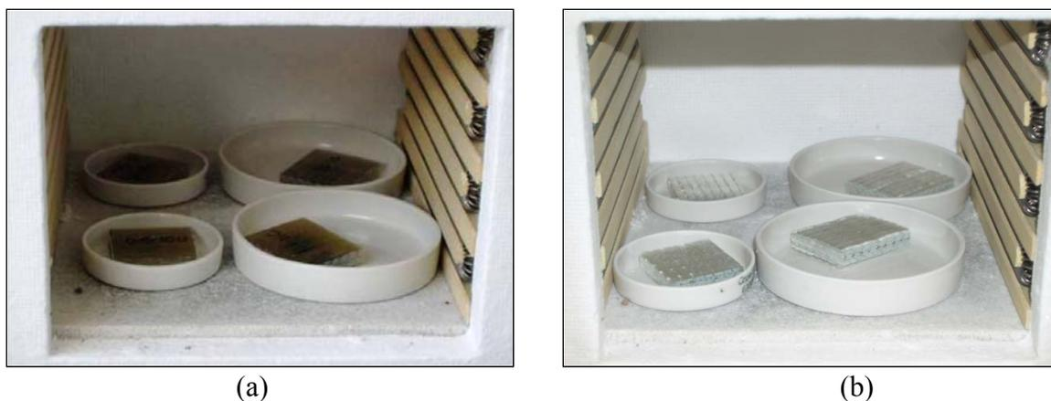
Figura 3.2. Muestras (a) antes y (b) después de la quema de la resina.
