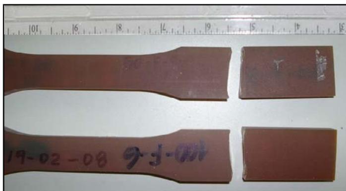
Figura 4.5. Muestras ensayadas de resina viniléster con falla en la parte ancha del espécimen.
