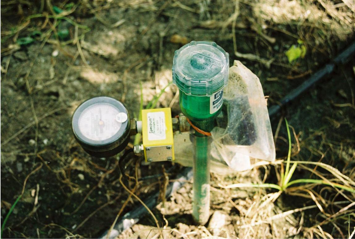
Foto 6: Tensiómetro instalado en la unidad experimental en la Finca Magdalena
