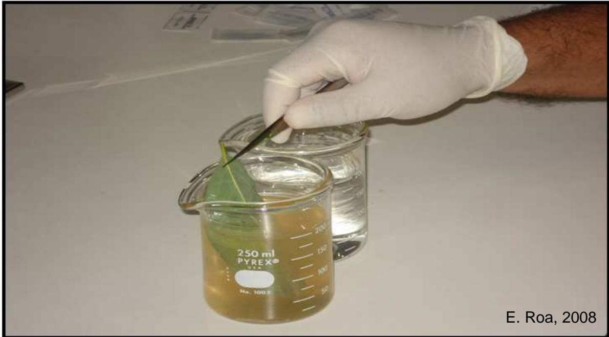
Figura 3.6. Forma en que fueron sumergidas las hojas de aguacate en las soluciones de insecticidas para las evaluaciones de mortandad de *P. perseae* en condiciones de laboratorio.
