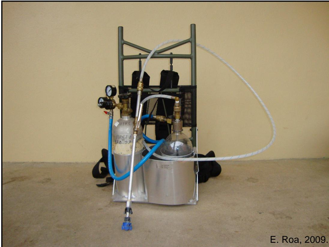
Figura 3.4. Atomizador impulsado por CO<sub>2</sub> utilizado para realizar las aplicaciones foliares de los insecticidas.
