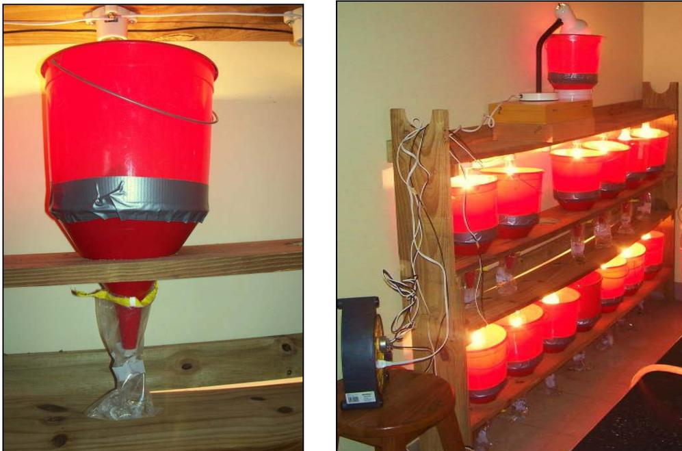
**Figura 4-16.** Montaje de los baldes para llevar a cabo la extracción con el embudo de Berlese (Laboratorio de Limnología de la UPRM, Mayagüez - mayo 2010)
