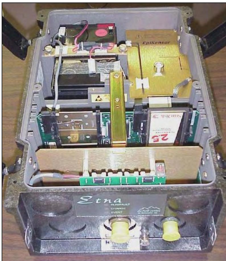
**Figura 4.7: Acelerógrafo Etna de la compañía Kinemetrics.**
