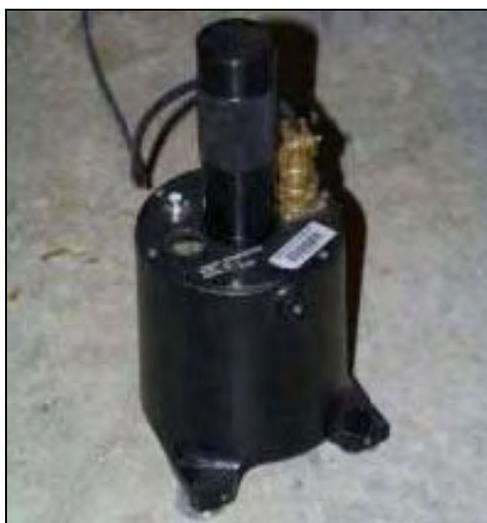
**Figura C-1: Sismómetro uniaxial de banda ancha (WR-1).**
