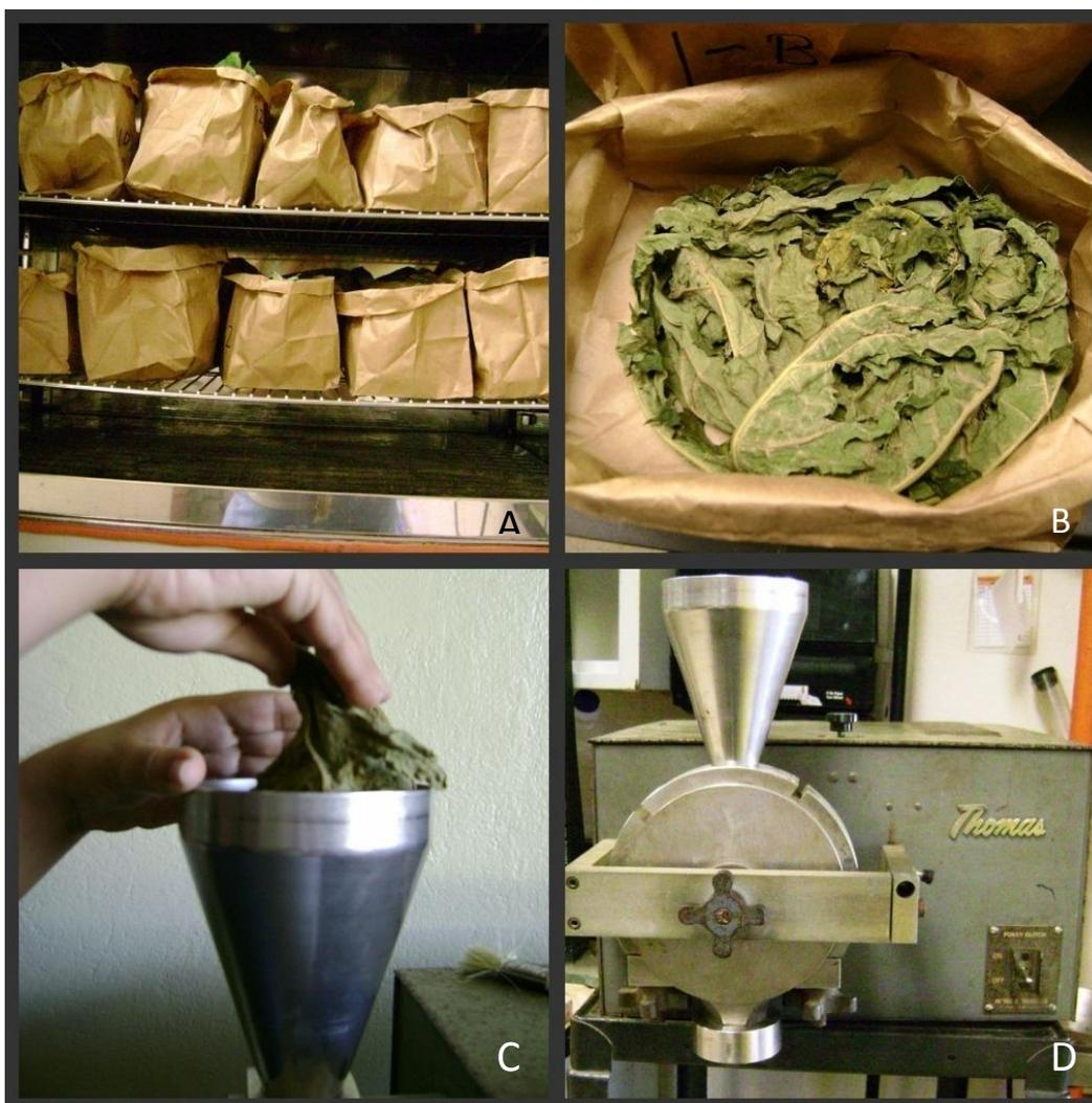
Figura 8. Proceso análisis de tejido (A-B) Hojas colocadas en bolsas de papel y secadas al horno a 65 °C durante 48 horas; (C-D) muestras procesadas en un molino de tejido *Laboratory Mill, Standard Bench Model*, Thomas-Wiley.
