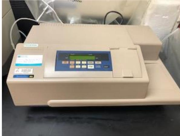
Figura 6. Espectrofotómetro
