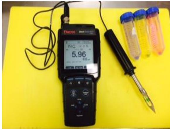
Figura 2. Thermo Scientific™ Orion™ Star A321 pH Portable Meter
