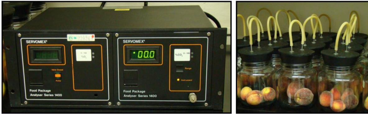
**Figura 3.** Equipo para medir el porcentaje de CO<sub>2</sub> y envases de vidrio donde se recolectaba la muestra del gas.
