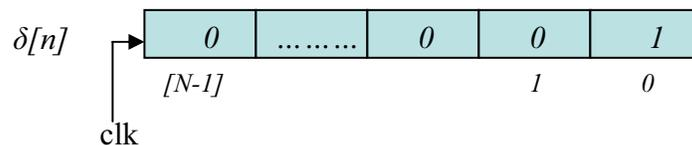
**Figura 8. Diagrama de Bloque de Registro Función Unidad Delta**
