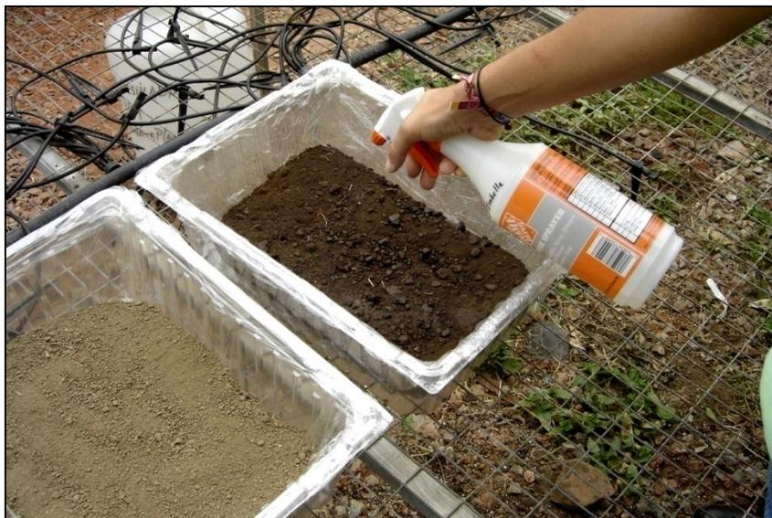
Figura 7. Aplicación de agua destilada para llevar a capacidad de campo.
