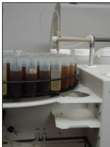
Figura 10. Plasma de Acoplamiento Inductivo con muestra de Extracción Secuencial
