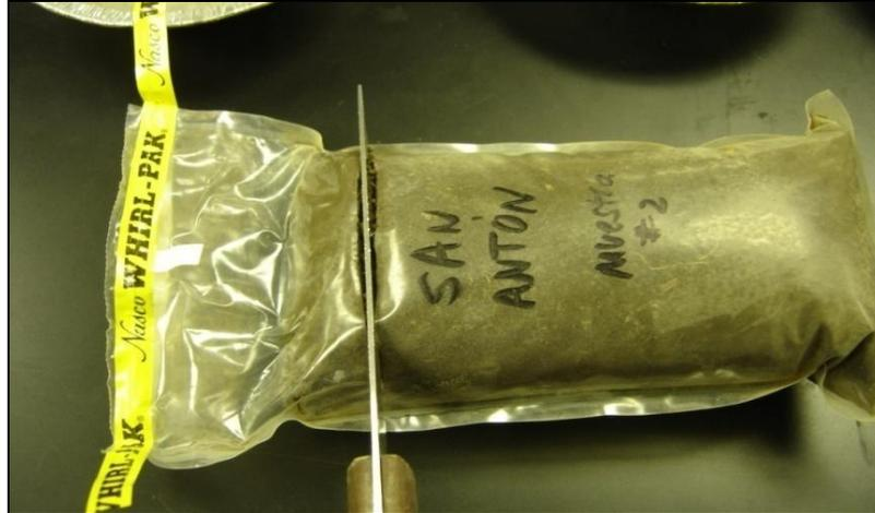
Figura 3. Corte de 2.5 cm del extremo superior de la muestra del suelo.
