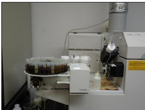
Figura 9. Plasma de Acoplamiento Inductivo
