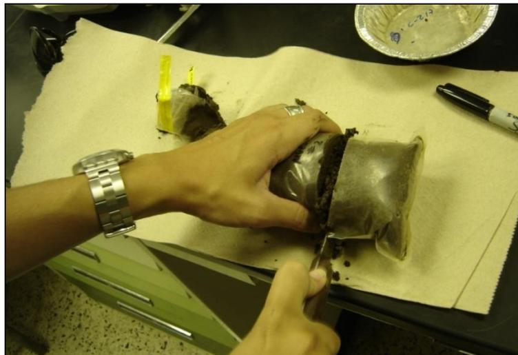
Figura 4. Corte de 5 cm de la parte inferior de la muestra de suelo.
