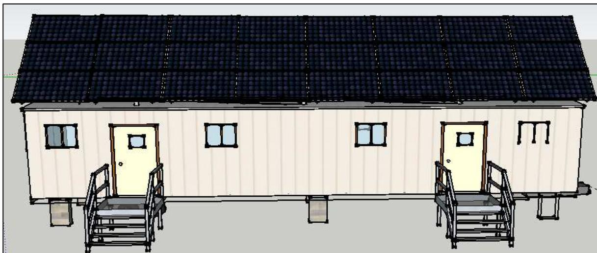
**Figura 5.31 Conceptual Oficina de Proyectos con Sistema Fotovoltaico 24 paneles – escenario #1**
