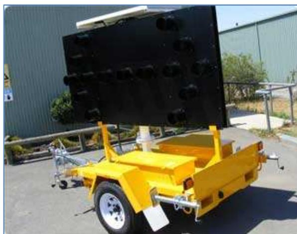
**Figura 3.12 Sistema solar portable de señalización de tráfico**
