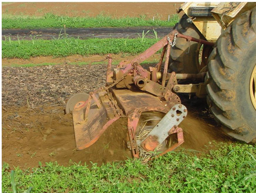
**Figura 4:** Cultivadora incorporando la biomasa seca de *Mucuna deeringiana* (Bort.) Merr., producida por los tratamientos 1 y 3.
