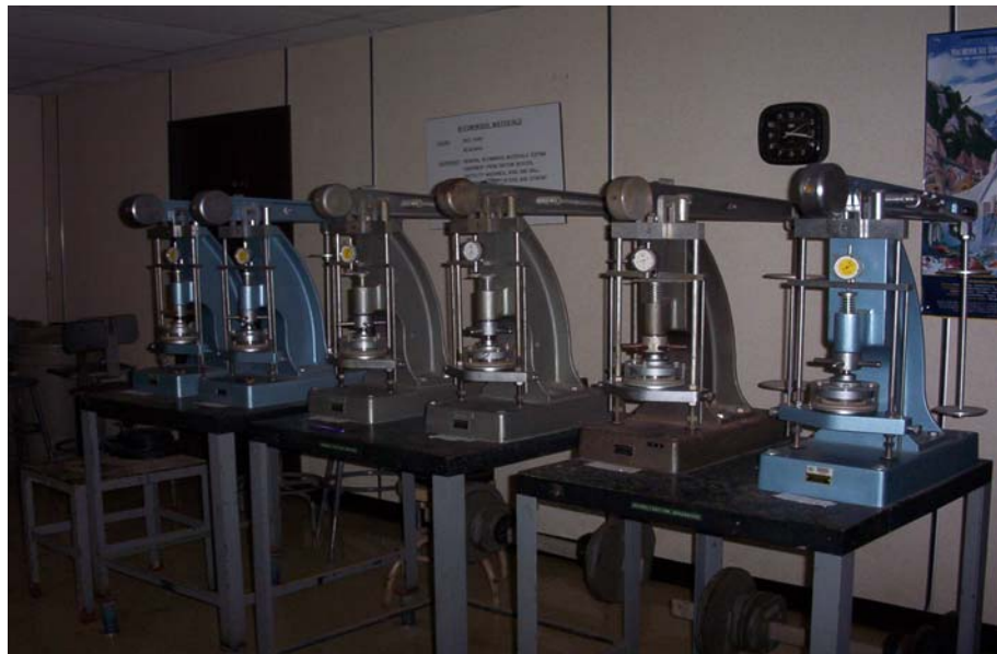
Figura B- 10 Equipo utilizado para el ensayo de compresibilidad a largo plazo
