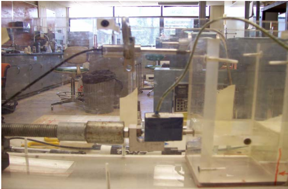
Figura C- 1 Configuración inicial de dispositivo para aplicación de carga en el muro de plexiglás
