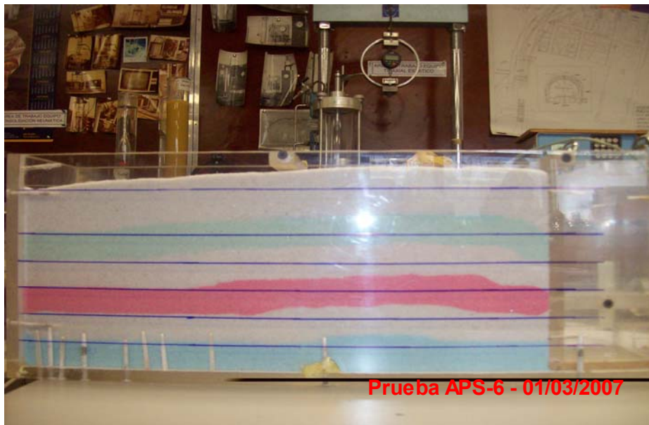
Figura D- 2 Fotografía después de la prueba pasiva en la arena
