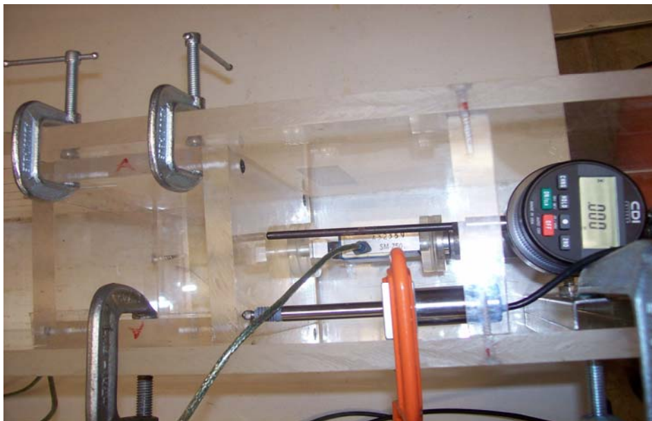
Figura C- 2 Configuración No 2 de dispositivo para aplicación de carga en el muro de plexiglás
