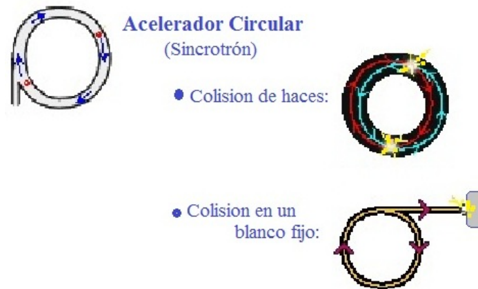
Figura 1-10: En la salida de los aceleradores sincrotrón, los haces pueden ser utilizados en los experimentos de colisión y experimentos de blanco fijo [2].
