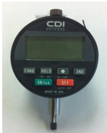
Figura 3.10 Fotografía del flexímetro utilizado para medir deformaciones en la prueba de corte directo y triaxial
