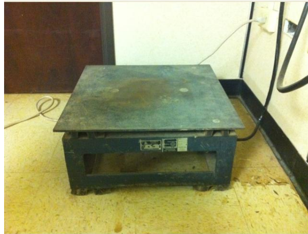
Figura 3.5 Fotografía de la mesa vibratoria utilizada para la determinación del peso unitario máximo ( \gamma_{\max} )
