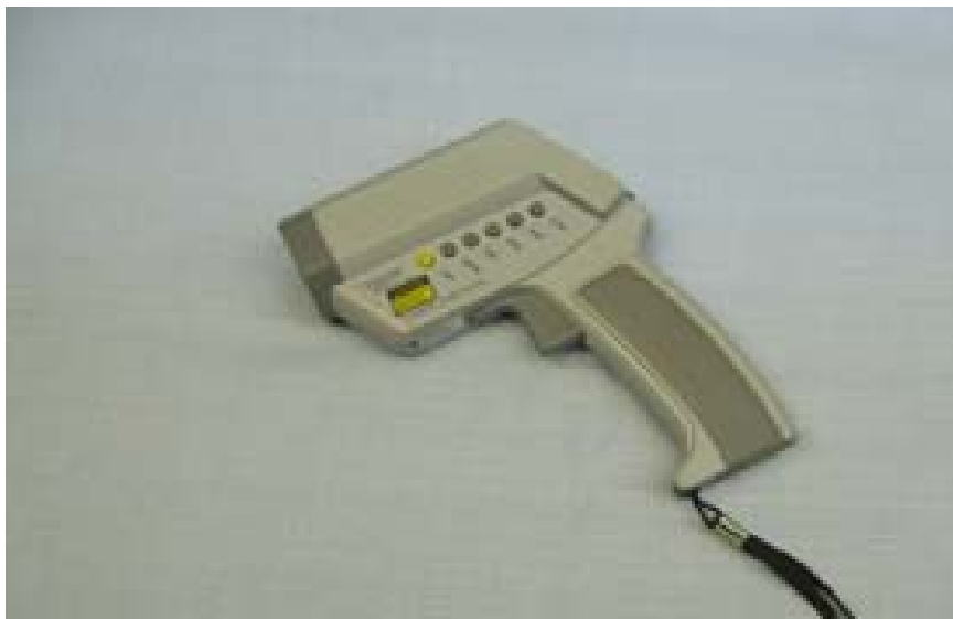
Figura 4. Termómetro infrarrojo usado para medir temperatura superficial.
