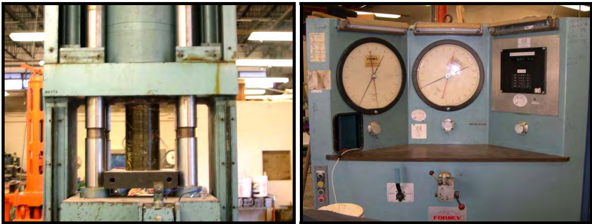
a) Marco de pruebas y espécimen CFFT instalado para el ensayo.
