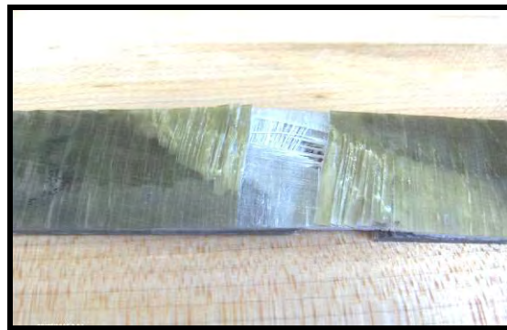
b) Fractura en dirección oblicua y efectos de delaminación local.
