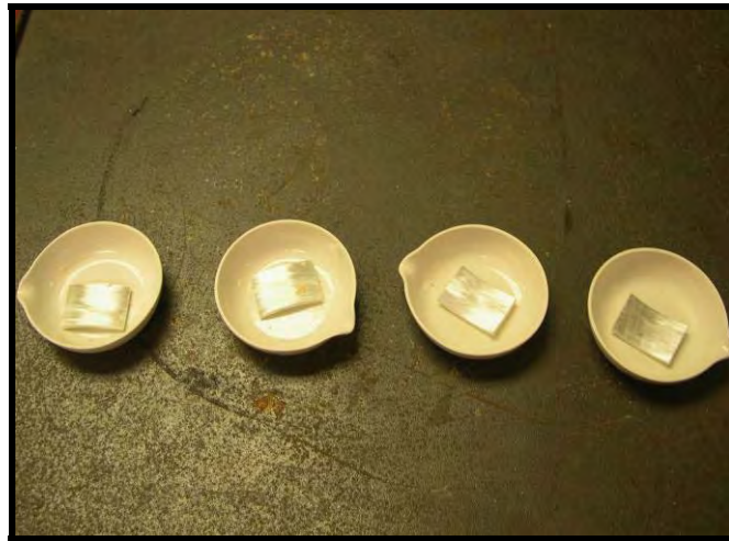
Figura 3.6. Exposición del refuerzo después de la remoción del contenido de resina.
