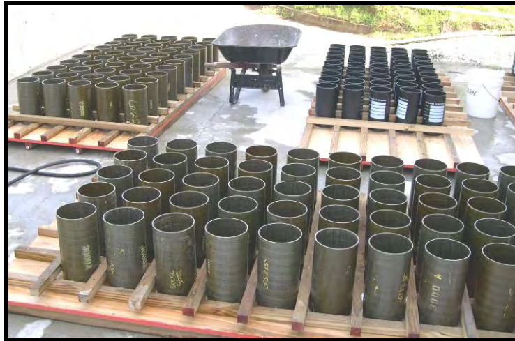
Figura 3.1. Instalación de especímenes en plataformas auxiliares de madera.
