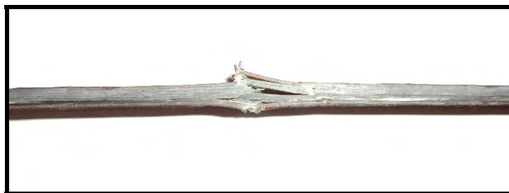
b) Detalle del efecto de delaminación expansiva.
