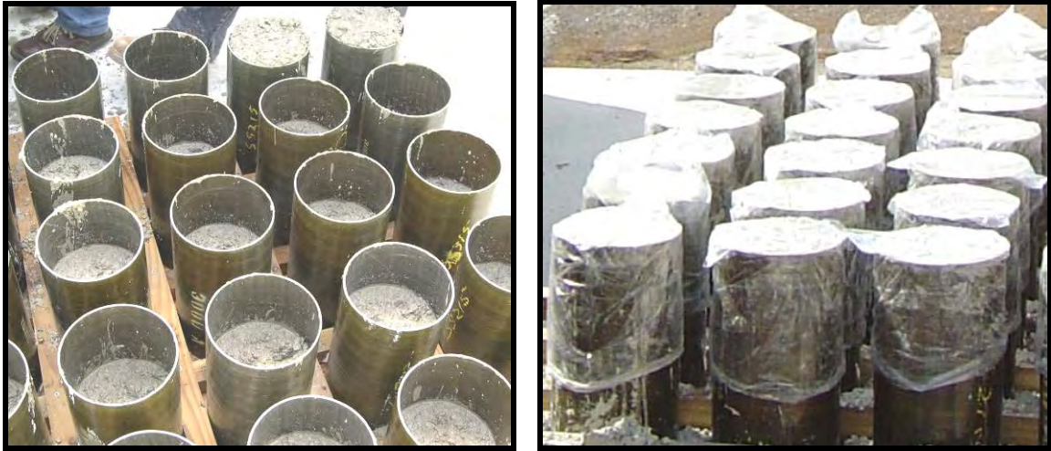
a) Llenado manual de la mezcla de hormigón en los tubos de FRP.
