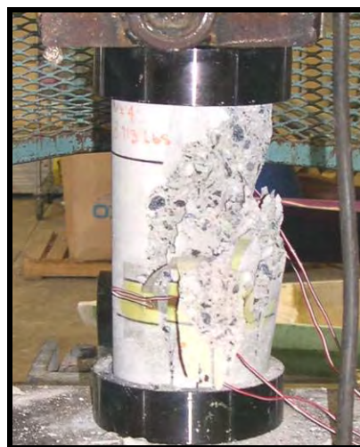
b) Fractura y Falla explosiva. (Especímen con diámetro 102 mm.)
