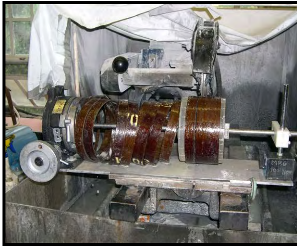
Figura 3.15. Obtención de los especímenes para la prueba de tensión circunferencial.
