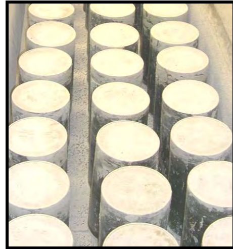
b) Elementos CFFT durante el curado en condiciones ambientales.
