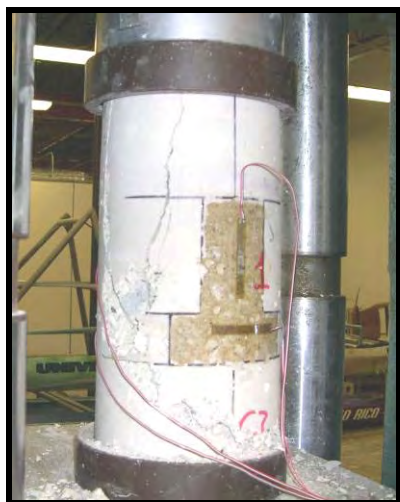
a) Fracturas de orientación múltiple. (Especímen con diámetro 152 mm)
