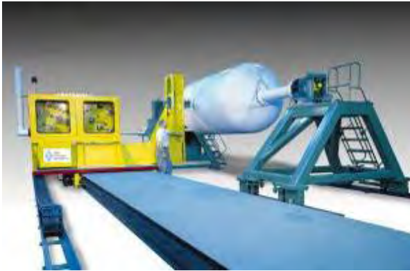
a) Equipo Fw5000 “Filament Winder”. (Entec, pag. web, 2006)
