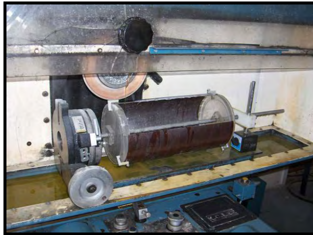
Figura 3.9. Muestreo de secciones longitudinales para el ensayo de tensión.
