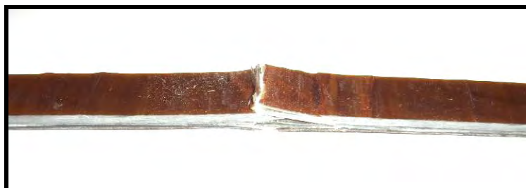
a) Ruptura de las fibras en la región media del espécimen.
