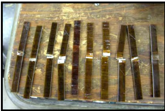
a) Falla por ruptura de las fibras en la sección central.
