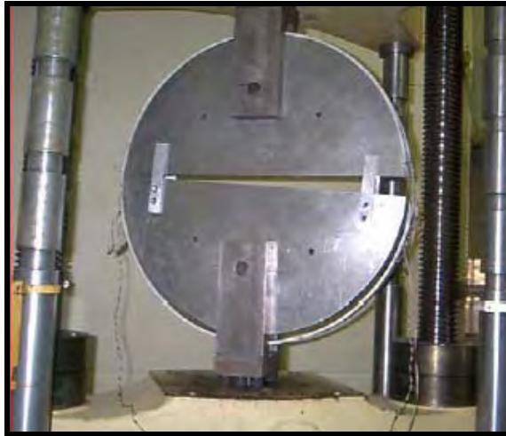
Figura 3.14. Disco para ensayo en tensión circunferencial (Adaptada de (Pando, 2003)).
