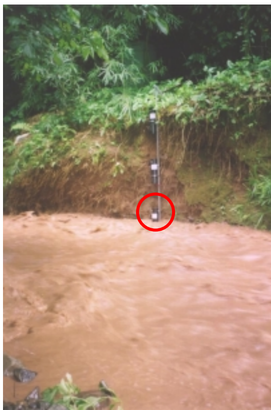
Figura G.1. Muestreo con botella fija en punto de cierre de micro cuenca Cerro Gordo
