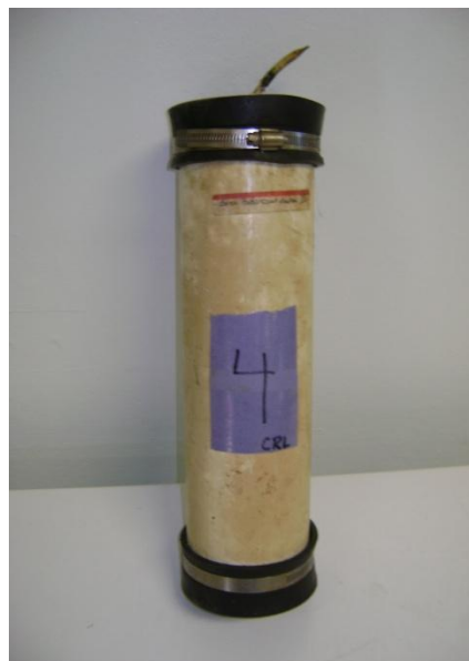
Figura 4. Microsilos con válvulas de gas
