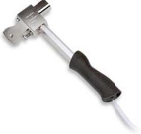
A specialized axe with a black handle and a silver metal head. The head has a unique design with a small nozzle-like opening at the top, connected to a thin white tube. | <p>El hipo-hatchet es un hacha con un sistema interno de aplicación de herbicida conectado por una manguera a un recipiente externo que contiene la solución. Cuando el hacha golpea el árbol, el filo de la hoja penetra la corteza. El impacto del golpe dirige el pistón hacia adelante dejando 1 ml de herbicida en el corte.</p> |
