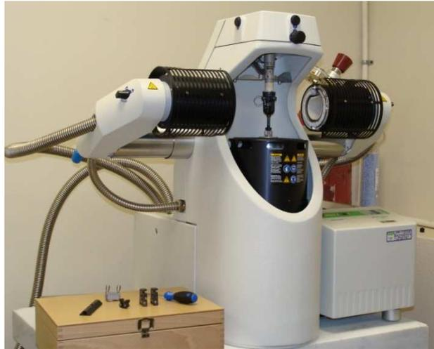
**Figura 3.12 Fotografía del equipo utilizado para las pruebas de DMA**
