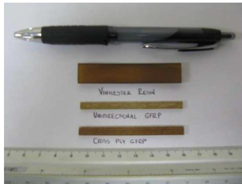
**Figura 3.13 Dimensiones finales de las muestras utilizadas para la prueba de DMA**
