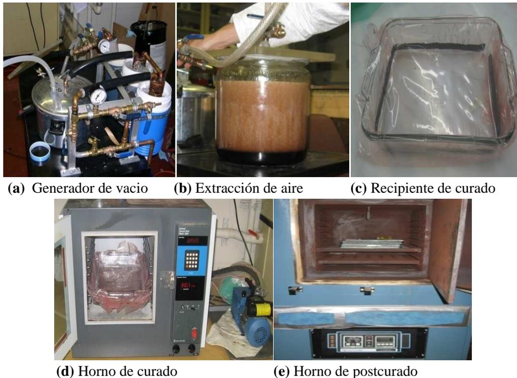
**Figura 3.1 Fotos mostrando el proceso de fabricación de la resina**
