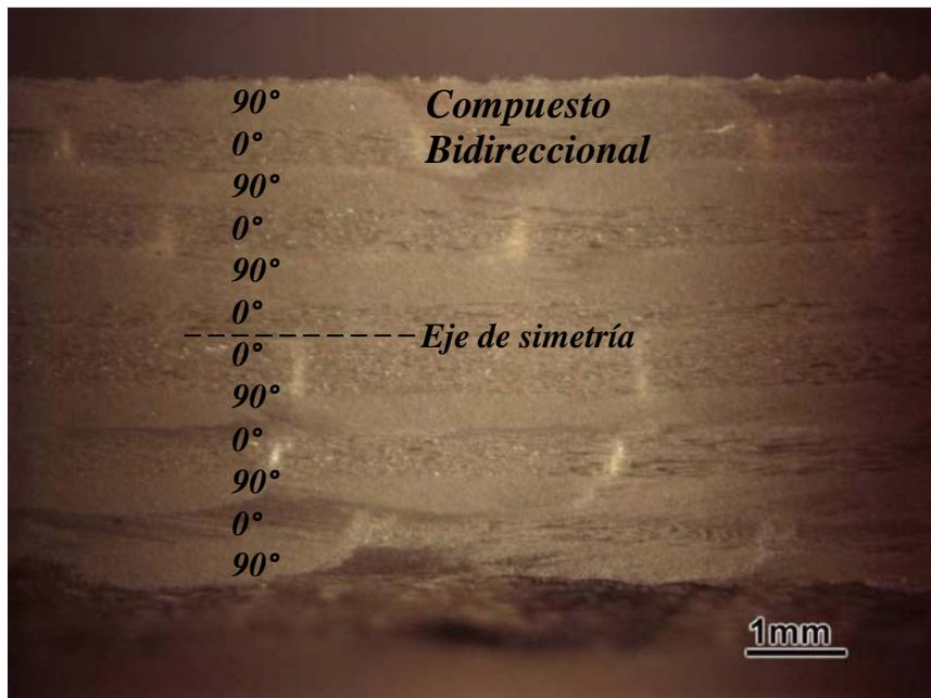
Figura 3.5 Fotografía del espesor del compuesto bidireccional
