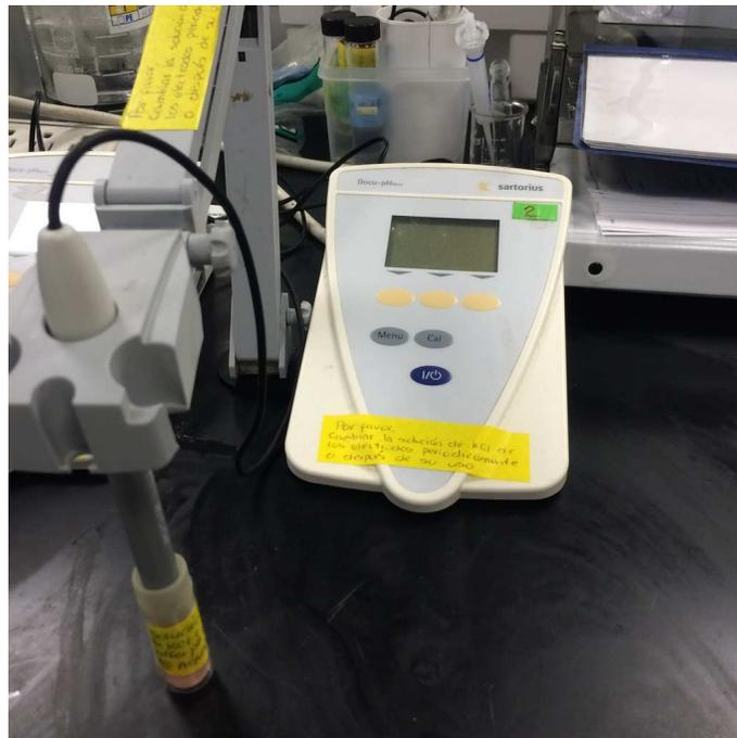
**Figura 29. Análisis de pH: Potenciómetro digital**
