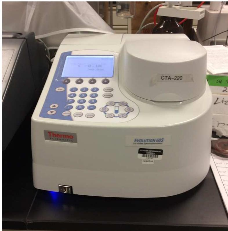
**Figura 32. Espectrofotómetro utilizado para análisis enzimático de lactosa.**
