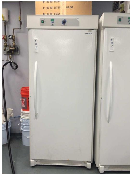
**Figura 25. Incubadora utilizada para proceso de fermentación.**
