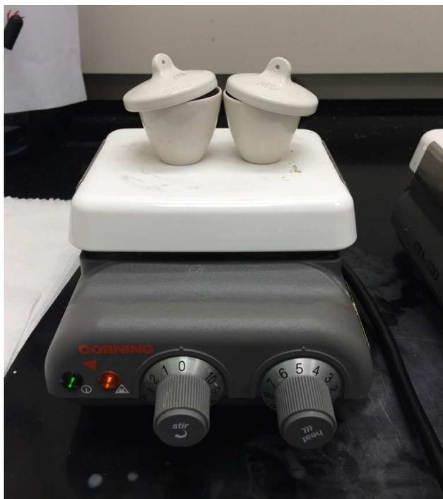
**Figura 42. Proceso de pre-secado para Análisis de cenizas**
