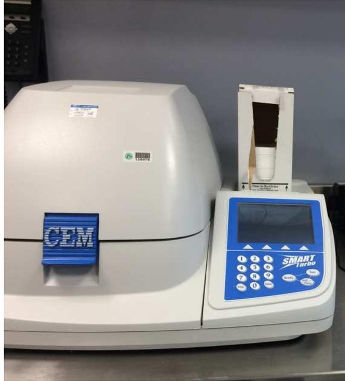
**Figura 28. Equipo CEM. (utilizado para medir humedad y sólidos totales como método rápido durante la elaboración del producto).**
