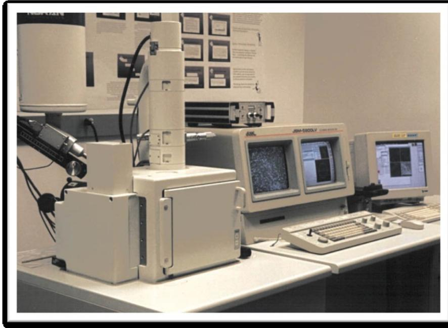
**Figura 4-7: Microscopio Electrónico de Barrido (MEB) del Departamento de Biología-UPRM.**
