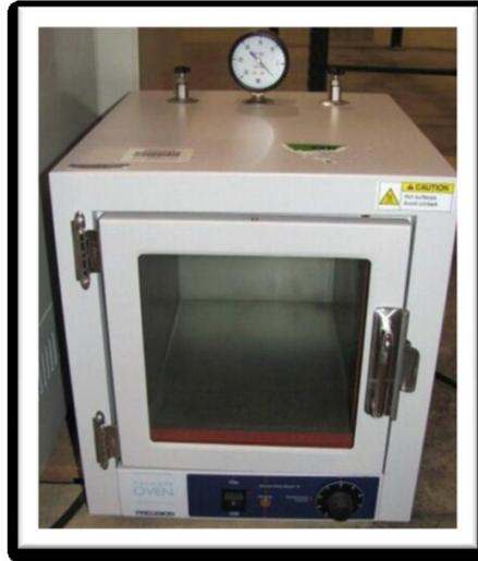
**Figura 4-5: Horno de vacío.**
