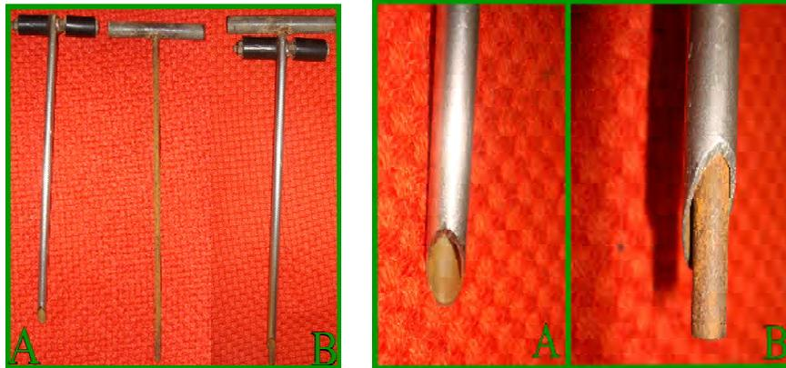
Figura 21. Removedor de ápice utilizado por Green (1978) para capar las plantas.
