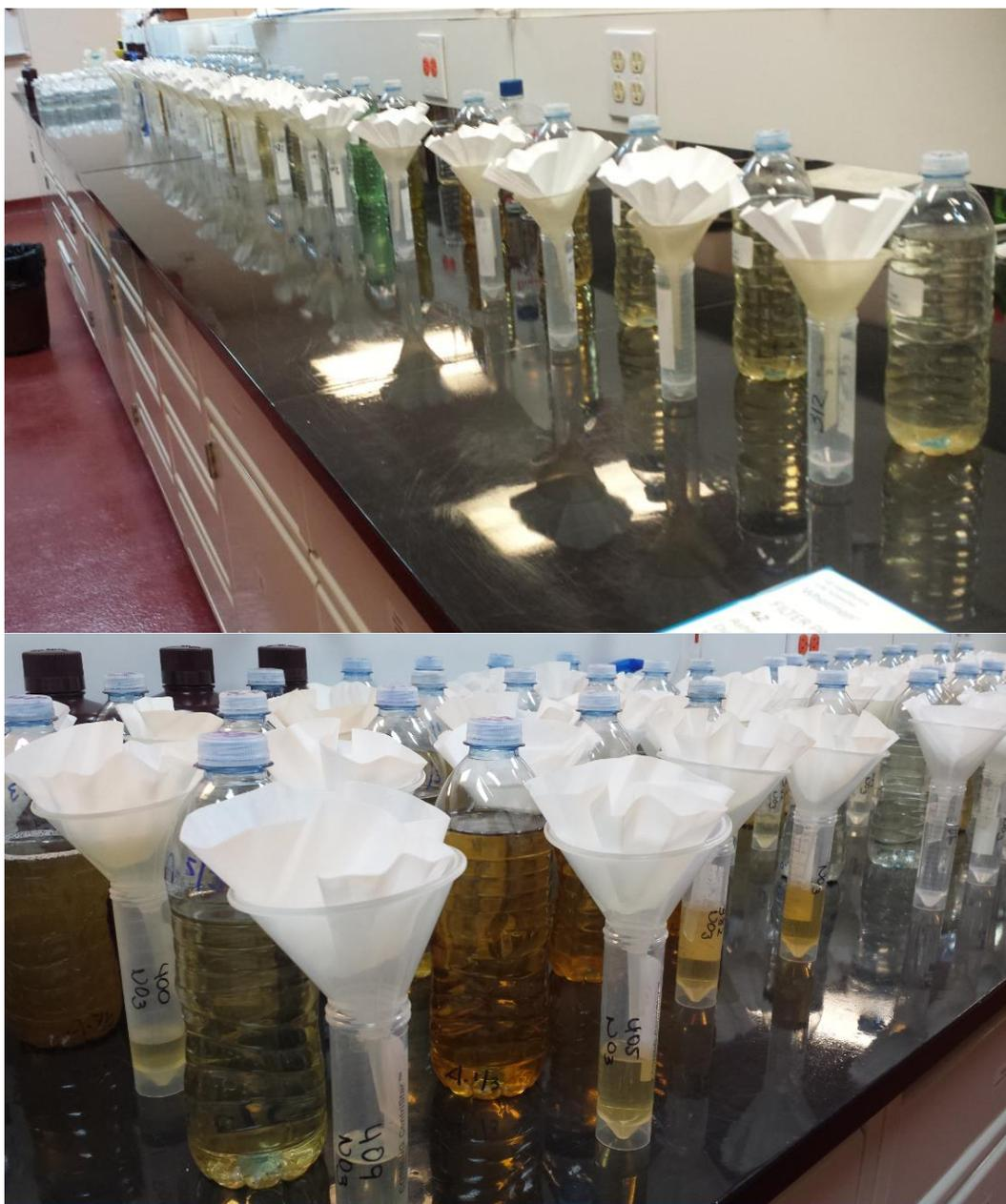
Figura 3.5: Filtración de nitrato por medición directa.
