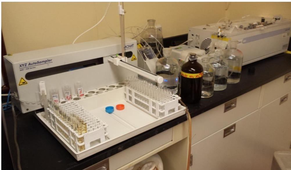
Figura 3.4: Espectrofotómetro QuikQuem® 8500 de la compañía Lachat para determinación de nitrógeno orgánico total, fósforo total y nitrato.
