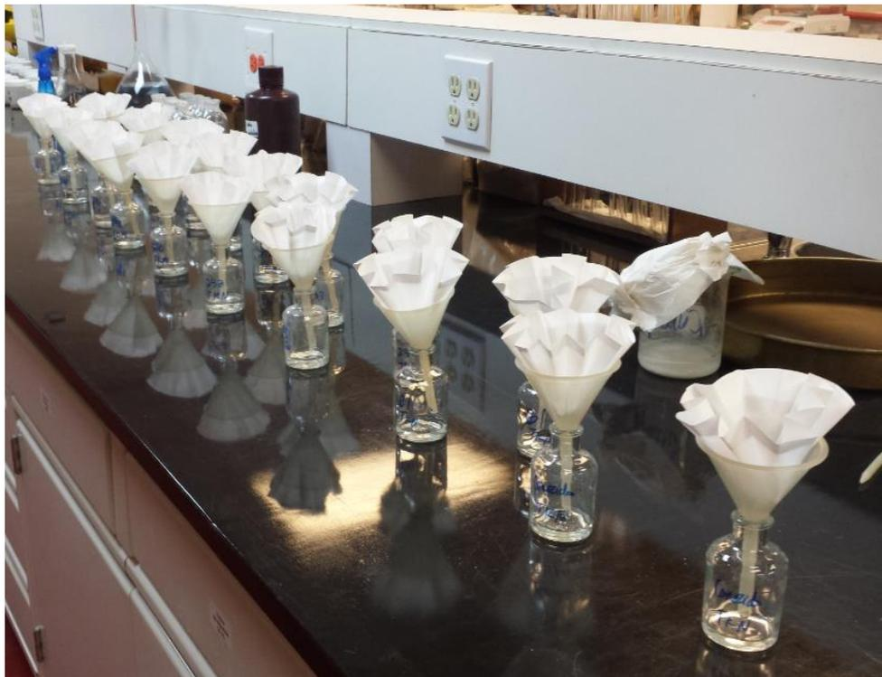
Figura 3.3: Filtración de muestras para determinación química de nitrógeno orgánico total y fósforo orgánico total.
