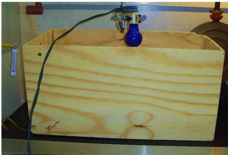
Figura 7.a. Cámara de germinación
