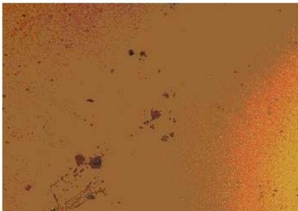
**Figura VII-3: Foto de Si(111) tomada con el microscopio óptico a una magnificación x10. En esta foto se puede ver una cantidad considerable de defectos en la superficie del sustrato.**
