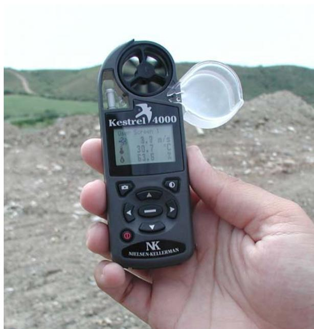
**Figura 5.** Instrumento Kestrel 4000 utilizado para monitorear condiciones ambientales durante los muestreos (Fotografía tomada por Yanitza Padilla, 2003).
