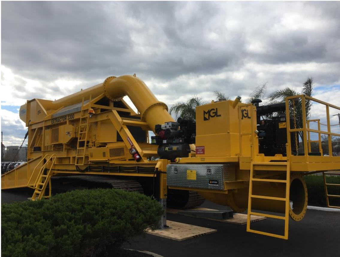
Figura 32: Maquinaria utilizada para limpiar la arena antes de colocarla en la playa.
