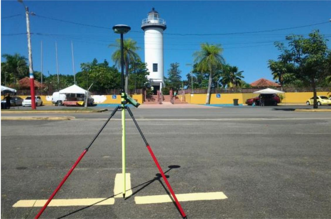
Figura 41: Control fotogramétrico frente al Faro de Rincón (Fuente: Global Matrix Engineering)
