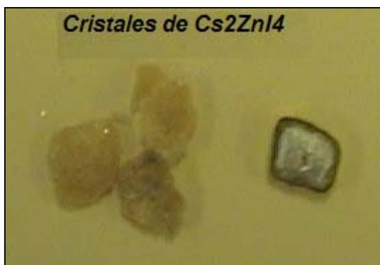
Figura 4.1: Cristales de Tetraiodozincato de cesio  $\text{Cs}_2\text{ZnI}_4$
