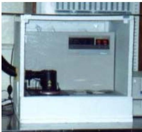
Figura 5.2: Módulo 2920 del calorímetro diferencial de “TA Instrumens”
