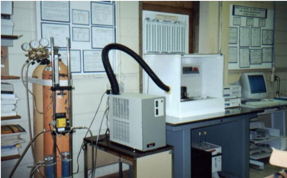
Figura 5.1: Calorímetro diferencial de barrido “DSC”
