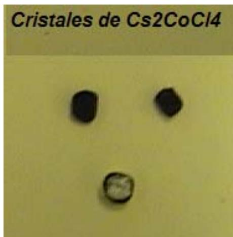
Figura 4.2: Cristales de Tetraclorocobalto de Cesio  $\text{Cs}_2\text{CoCl}_4$
