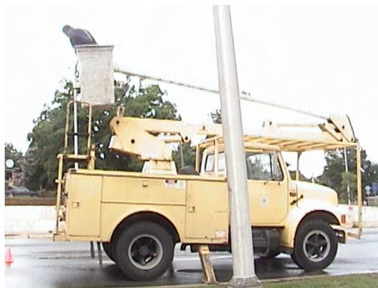
**Figura VI-1 Camión con Canastilla.**
